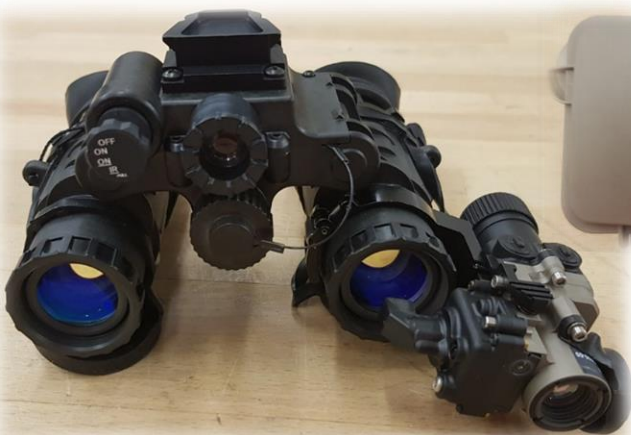
pro noční operace - clip-on kamera + kompas + GPS s metadaty v software MyVector
