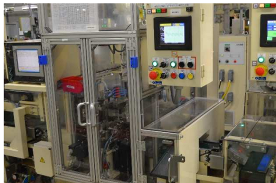
Kontrola průměru a kruhovitosti oběžné dráhy
