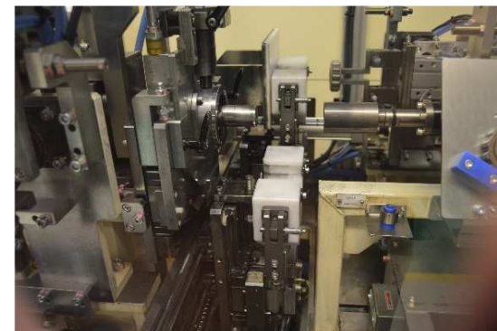
Akustická hluková kontrola
