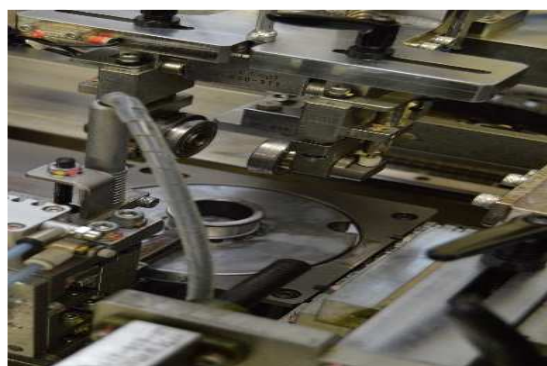
Kontrola šířky a průměru oběžné dráhy
